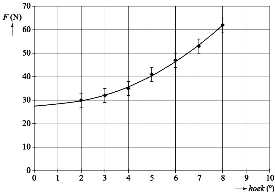
Het snijpunt met de verticale as geeft de spankracht van de snaar als er niet aan getrokken wordt:  $F_{\text{span}} = 27 \text{ N}$ .
